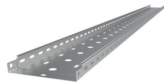
В лотках типа ЛПМ и ЛПМЗ наличие перфорации по дну и бортам обеспечивает вентиляцию внутреннего объема, что исключает конденсацию влаги при перепадах температур. «Глухой» лоток имеет перфорацию только под соединительные элементы.
